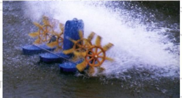
**Лопастной (гребной) аэратор, тип РРА**
