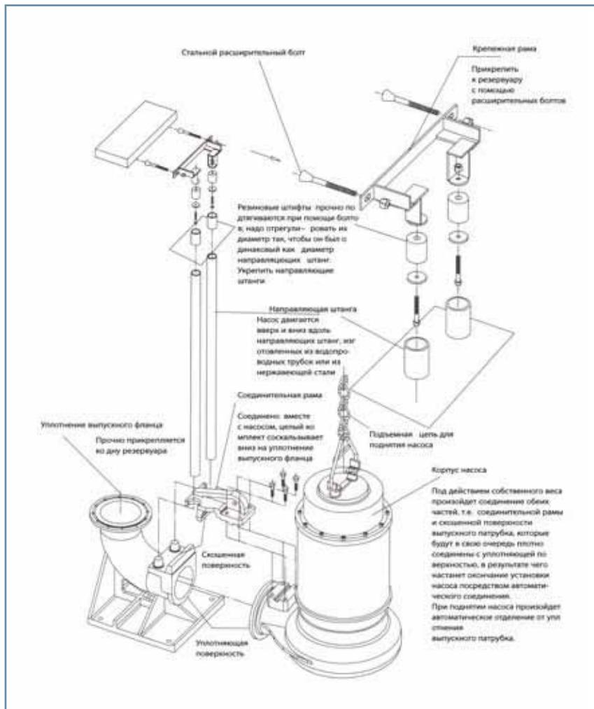
Насос под действием собственного веса стоит на фундаментной плите, неподвижный фланец присоединен к трубопроводной сети.
